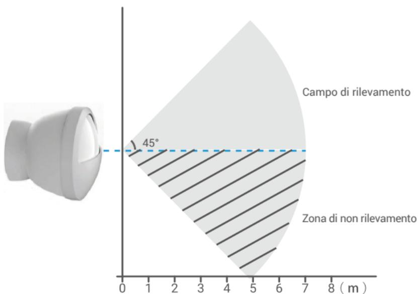
Fig. 2 Vista superiore del campo di rilevamento
