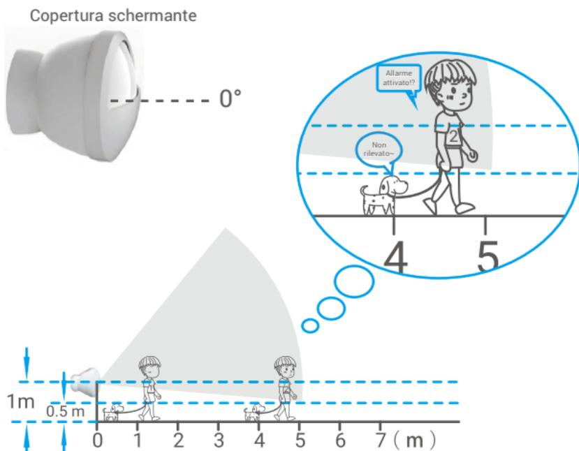
Fig. 1 Vista laterale del campo di rilevamento
