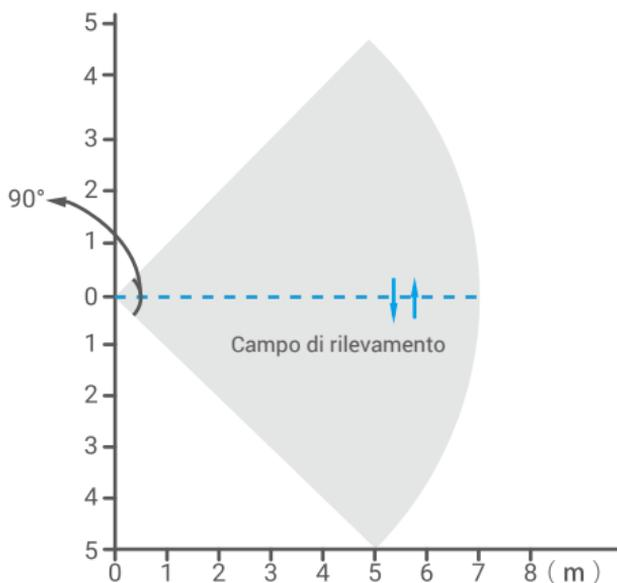
Fig. 2 Vista superiore del campo di rilevamento
