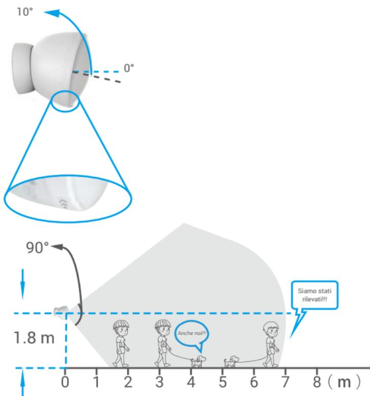
Fig. 1 Vista laterale del campo di rilevamento
